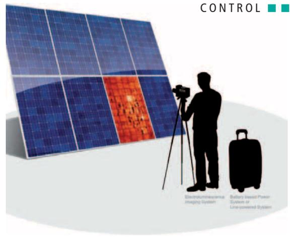
Das innovative LumiSolarOutdoor System erlaubt erstmals die Inspektion von Solaranlagen unter freiem Himmel nach der Dämmerung.
